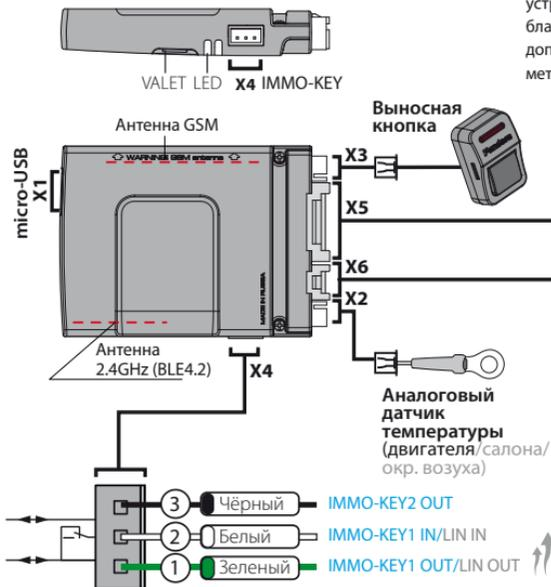
**ВНИМАНИЕ!** Перед началом монтажа системы: ознакомьтесь с актуальной информацией по подключению к автомобилю размещённой на сайте [loader.alarmtrade.ru](http://loader.alarmtrade.ru); обновите основное ПО и ПО Bluetooth-модема; при подключении к цифровой шине CAN выберите модель автомобиля.
