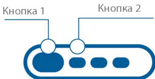
2. Через 3 секунды успешная регистрация будет подтверждена коротким звуковым сигналом брелока, 2 вспышками светодиода сервисной кнопки и 2 звуковыми сигналами. Если брелок не зарегистрировался, то последуют 4 звуковых сигнала брелока.
