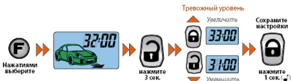
**Подуровень I-3.4** – Позволяет исключить дополнительный датчик из зон охраны при работающем двигателе (во время АЗ, ДЗ, ПЗ, ТТ). **Заводская установка - «ЗАПРЕЩЕНО»**.
