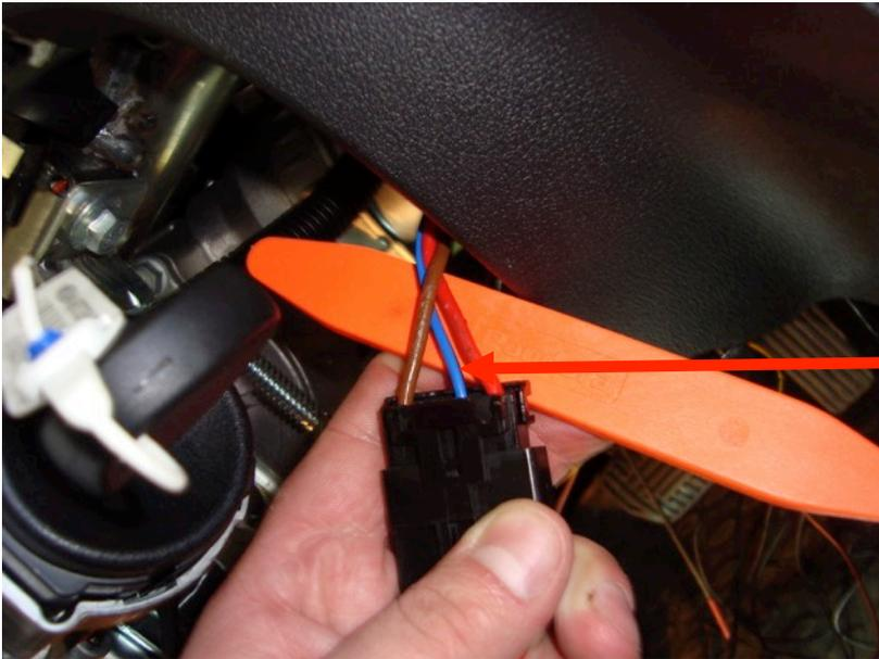
Синий провод - Зажигание
