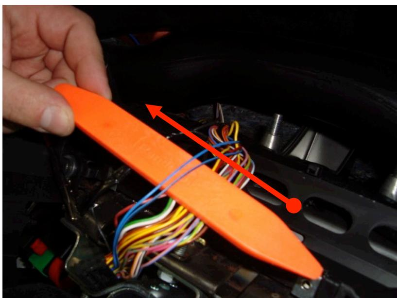
Световая сигнализация подключается к силовым проводам, синий и сине-черный в разьеме приборной панели, управление положительным потенциалом прямое.
