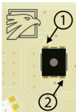
В случае потери метки необходимо удалить ее из памяти системы для предотвращения попыток угона. Для удаления метки следует изменить текущий PIN-код на тот же самый (см. стр. 13) и, не выключая зажигания, нажать 10 раз сервисную кнопку\*. Кнопку необходимо нажимать не позднее, чем через 10 секунд после подтверждения записи PIN-кода.
